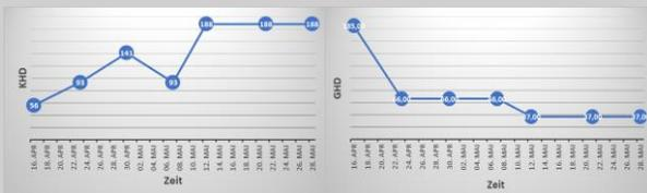
Abb.3: Die Karbonathärte stieg, während die Gesamthärte des Wassers sank.
