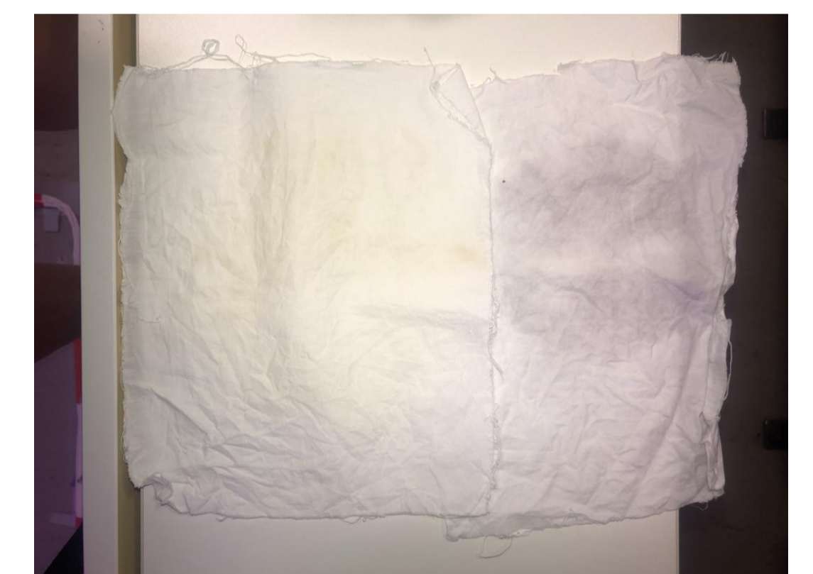
Abb. 4: Eine Färbung mit Chlorophyll (links) ist nicht lichtbeständig. Astaxanthin (rechts) ist bei geringer Lichtexposition leicht lichtbeständig.
